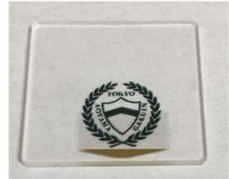
3層積層 + ドーピング  $R_s = 80 \Omega/\text{sq}$   $T = 90\%$
