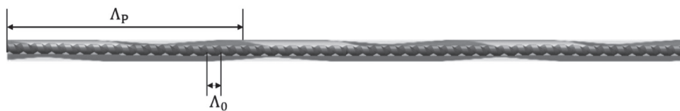
図5 螺旋サンプリング法を用いた多チャンネル HPLG の模式図
