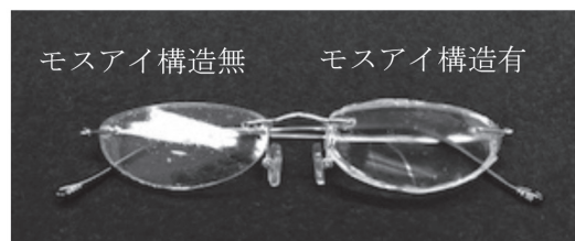
図6 反射防止構造を形成したメガネレンズ
